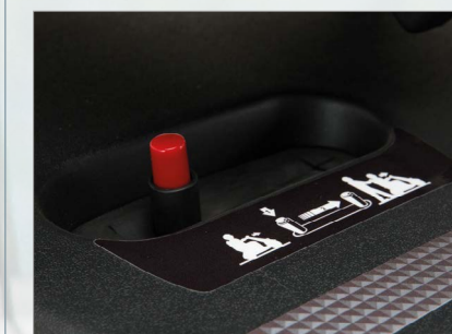
2-stegs frikoppling, för att förhindra frirullning
